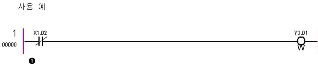
[ 그림 4.2 ] RDN 의 Ladder Diagram
