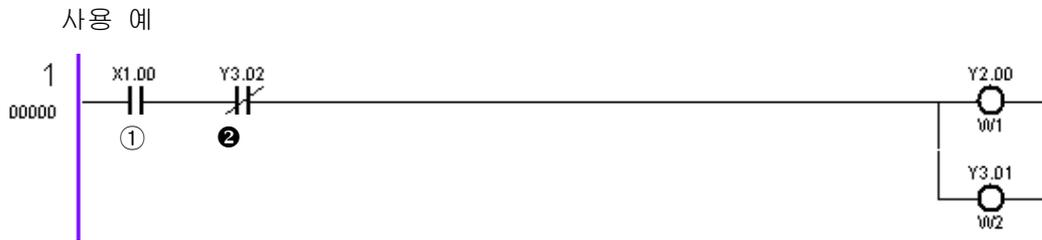
[ 그림 4.3 ] WR 의 Ladder Diagram
